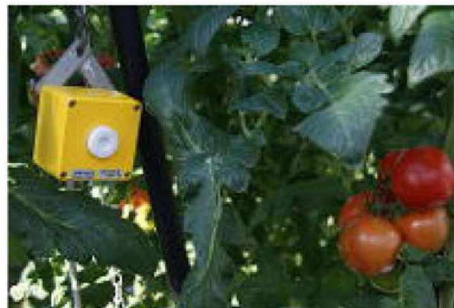
Фото 7. Датчик в центре культуры измеряет концентрацию этилена и передает данные в систему управления.
