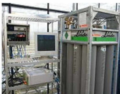
Фото 2: Станция управления и распределения со сбором данных и комплектом из 12 x 50L BANARG6 от Linde Gas
