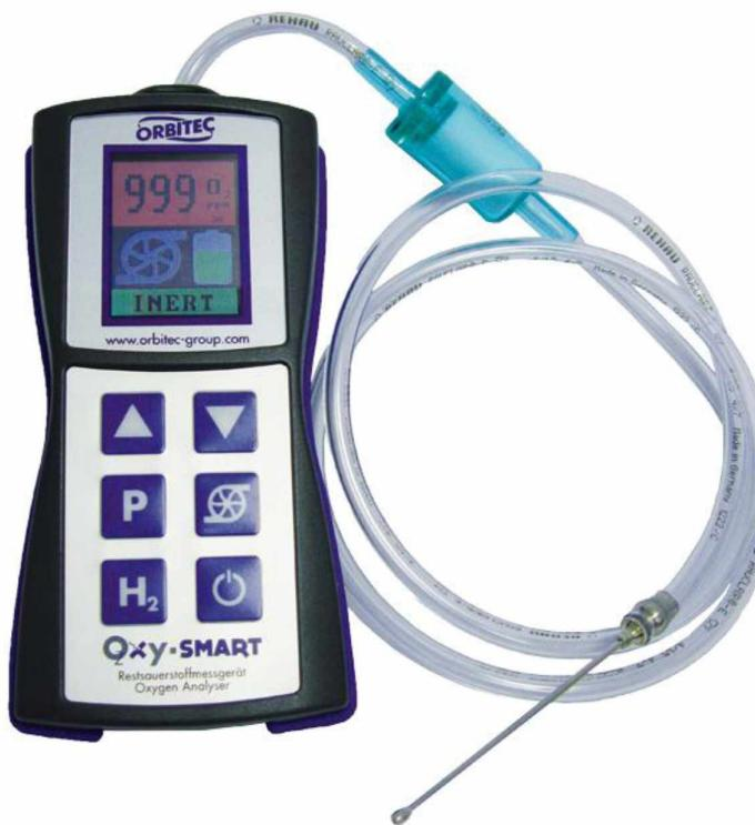
Анализаторы **Oxy Smart** предназначены для подачи защитного газа внутрь трубной конструкции качественного формирования корня при сварке нержавеющих сталей и высоколегированных сплавов, а также при определенных требованиях и углеродистых сталей. В обычных условиях достаточно вытеснить воздух инертным газом из внутренней полости свариваемых труб до значения 30 ppm (0,003%) кислорода.
