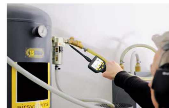
Течеискатель с направляющей трубкой
